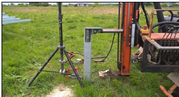
Figure 1 : Photo d'une foreuse pour travaux de géotechnique et études des sols / Essai de compression horizontale
